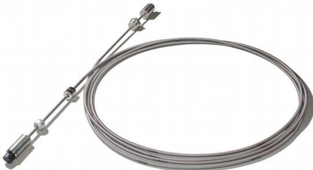
Le sonde di misura livello flessibili della serie AT17310 lavorano in base al principio di misura magnetostrittiva. All'interno del tubo corrugato è integrato un cavo di materiale magnetostrittivo.
